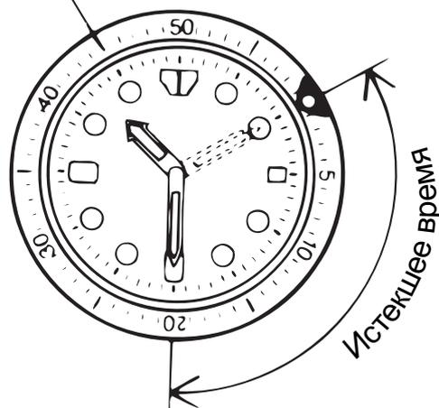
Кольцо не может поворачиваться в противоположном направлении, поскольку оно оснащено защитным механизмом, предназначенным для защиты от ошибочной операции в результате приложения силы или удара. Цифры на вращающемся кольце также могут упрощать считывание текущего времени.
