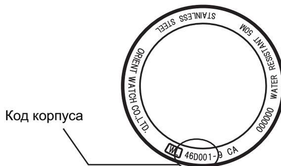
**Пример А:** Если код корпуса “FX01-C0”, то номер калибра — “FX”.
