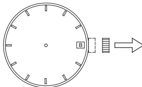
(2) Поворачивайте головку против часовой стрелки, пока не будет установлена текущая дата.
